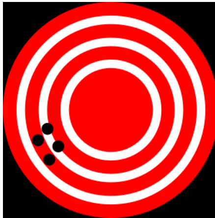
Abbildung 4b: hohe Präzision (precision), aber geringe Genauigkeit (accuracy)
